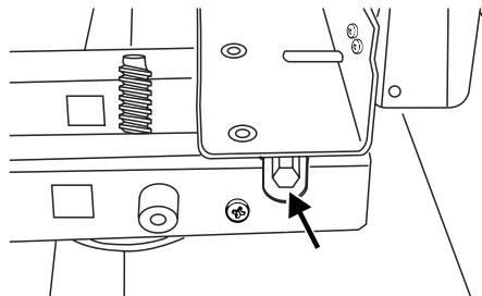
Justér højden af de forreste ruller for at sætte komfuret i vater. Drej dem i urets retning for at hæve komfuret og mod urets retning for at sænke det.
