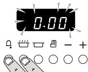
Hold nede som vist. På samme tid trykkes på (-) eller (+), indtil det korrekte klokkeslæt vises. Husk, at det er et 24 timers ur. Hvis du laver en fejl, eller trykker på den forkerte knap, skal du slukke for strømmen i et eller to minutter, og begynde igen.
