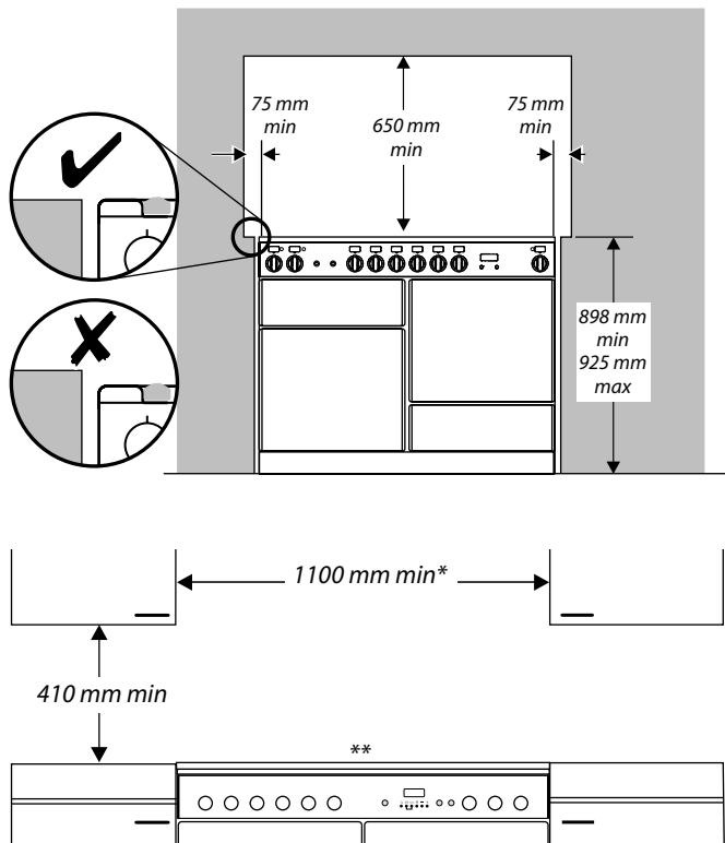
Kogefeltet skal være på niveau med eller højere end tilstødende arbejdsflader. Over kogefeltet skal der være en afstand på 7,5 cm mellem hver side af komfuret og tilstødende lodrette flader.
