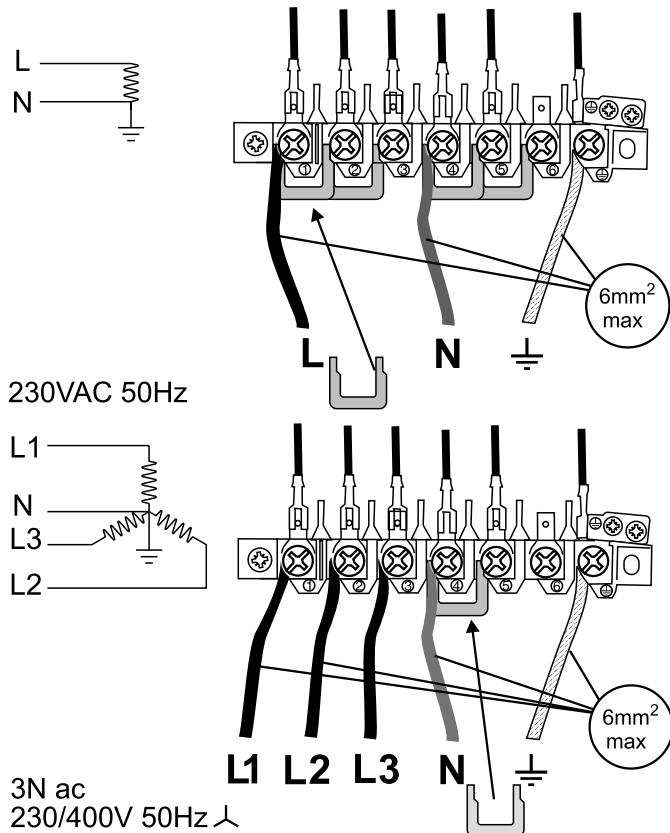
Check, at forbindelserne er korrekt sat på, og at klemmeskruerne er stramme. Fastgør elkablet ved brug af kabelklemmen.
