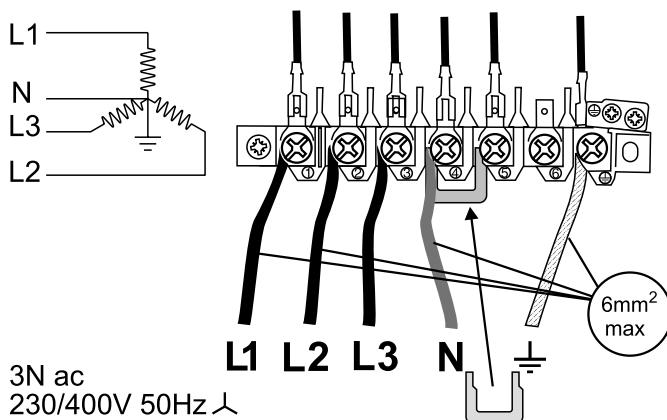
Sjekk at forbindelsene er montert korrekt og at tilkoblings-skruene er fast tiltrukket. Sikre nettkabelen med bruk av kabelklammen.
