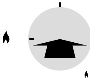
Trykk inn tenningsknappen eller tenn på med en fyrstikk. Hold kontrollbryteren trykket inn i omtrent 10 sekunder.
