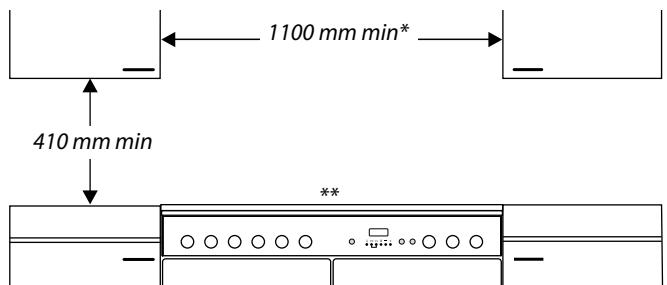
Kokeplatens innfatning skal være på nivå med, eller ovenfor, eventuell kjøkkenbenk ved siden av. Over kokeplatens nivå skal det være en avstand på 75mm mellom hver side av komfyren og en eventuell vertikal overflate ved siden av.
